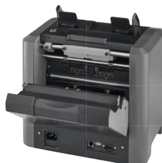
Nettoyage facile et extraction simple des billets de banque comprimés et accolés grâce à l'unité de transport à ouverture facile.
